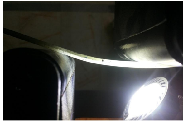
شکل 6 تعیین محل نوک ترک با روش نورپردازی
