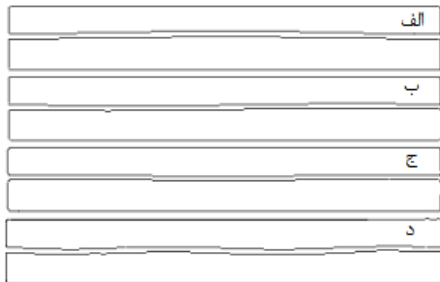
شکل ۱۸) اشکال مودی استخراج‌شده: الف. شکل مود اول ( \alpha=150 ) ، ب. شکل مود دوم ( \alpha=400 ) ، ج. شکل مود سوم ( \alpha=700 ) ، د. شکل مود چهارم ( \alpha=1000 ) _ (ارتعاش تصادفی تیر فولادی با اتصالات مفصلی)
