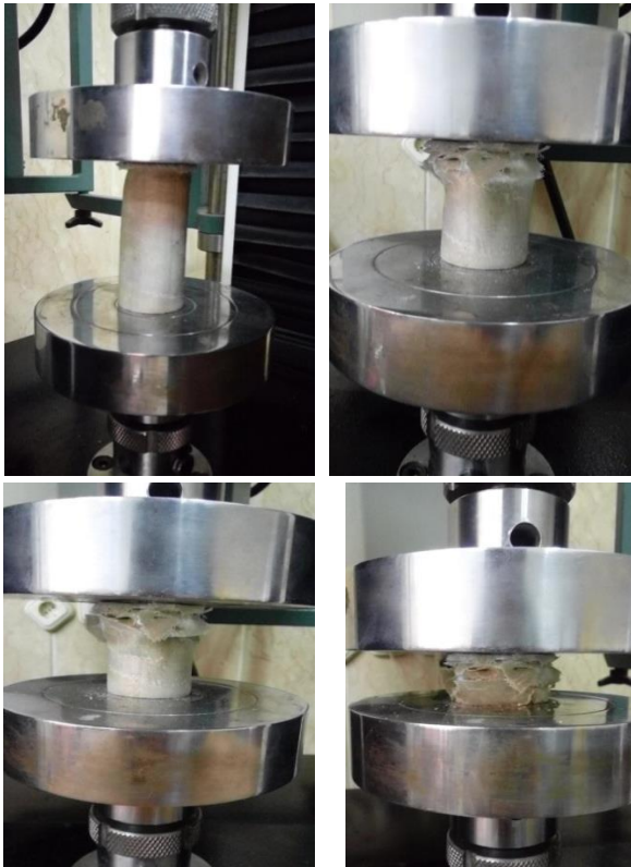
شکل ۱۱) نمونه ترکیبی آلومینیوم/کامپوزیت تحت بارگذاری فشاری شبه‌استاتیکی.
