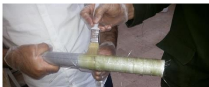
شکل ۶ پیچش باندهای پارچه‌ای بر روی لوله‌های آلومینیومی.
