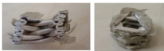
شکل ۱۸) نمونه ترکیبی آلومینیوم/کامپوزیت با درصد هم پوشانی ۵۰ درصد بعد از اعمال بارگذاری.
