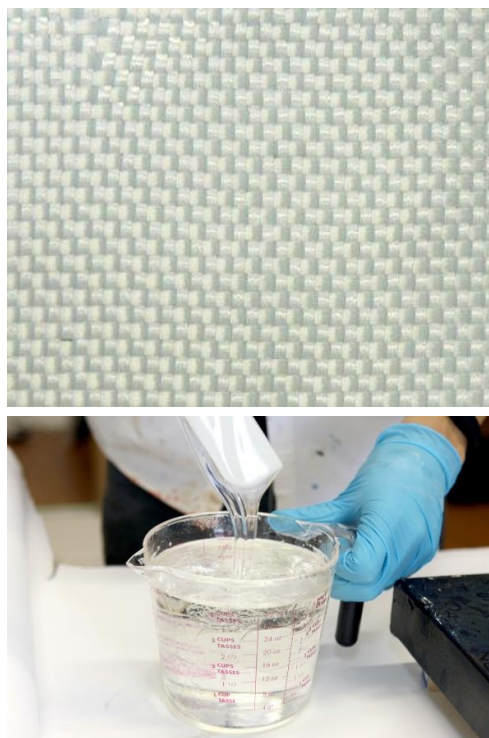
شکل ۲ پارچه از جنس شیشه و رزین اپوکسی.
