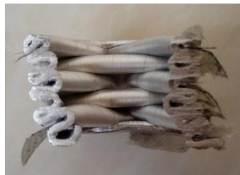
شکل ۱۵) نمونه ترکیبی آلومینیوم/کامپوزیت با درصد هم‌پوشانی ۵ درصد بعد از اعمال بارگذاری.
