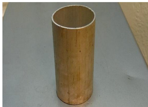
شکل ۱ پروفیل استوانه‌ای آلومینیومی استفاده شده در آزمایش‌ها.
