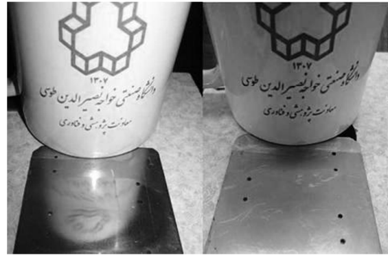
شکل ۱۳ تاثیر عملکرد پرداخت کاری سایشی مغناطیسی بر سطح ورق اینکونل ۷۱۸
