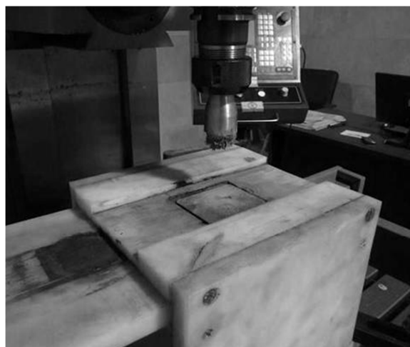
شکل ۴ انجام فرآیند پرداخت کاری سایشی مغناطیسی بر سطوح اینکونل
