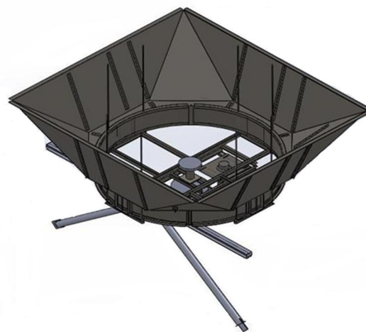
شکل 7 کانال هوایی به همراه سازه فن
