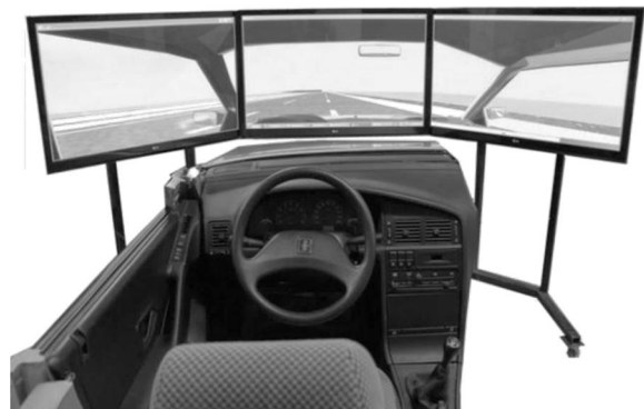
شکل 3 شبیه‌ساز رانندگی سکو ثابت پژو 405
