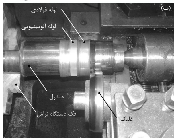
شکل 1 اتصال چرخشی: الف- فرآیند به صورت شماتیک؛ ب- فرآیند عملی روی دستگاه تراش
