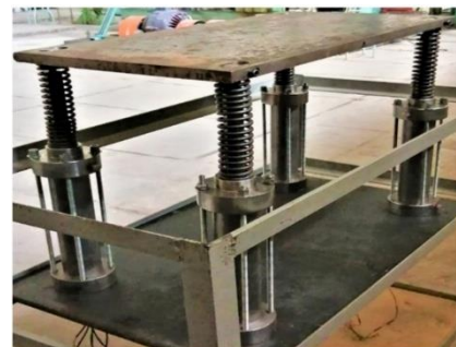
شکل ۸ سیستم تعلیق ثانویه مجهز به دمپرها، مگنتورئولوژیکال
