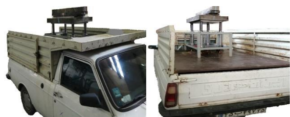
شکل ۹ مجموعه خودرو و محموله حساس به همراه سیستم تعلیق ثانویه
