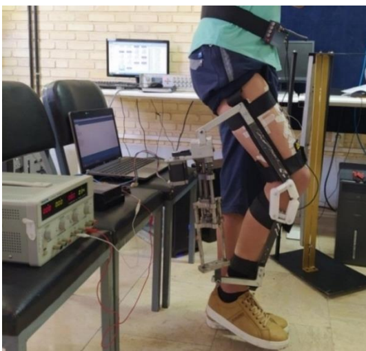
شکل ۱) ربات اسکلت خارجی یاری‌گر اس‌یوتی-نی‌اگرو به همراه عمل‌گر الاستیک سری
