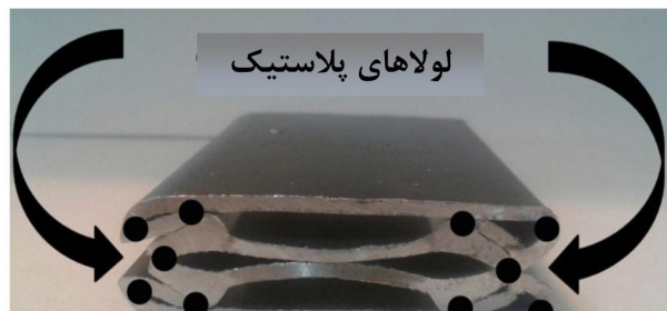
شکل 9 تشکیل پنج لولای پلاستیک در هر سمت نمونه، طی فرآیند پهن‌شدگی جانبی
