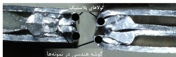
شکل 12 محل تشکیل لولاهای پلاستیک در نمونه‌های مشابه در دو حالت توخالی و پرشده از فوم پلی‌پورتان
