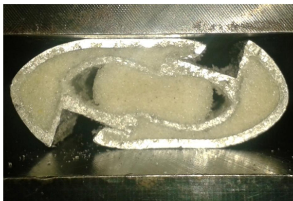
شکل 14 نمونه جدارنازک پر شده از فوم تحت بارگذاری با زاویه 45 درجه، در حین فرآیند پهن‌شدگی جانبی
