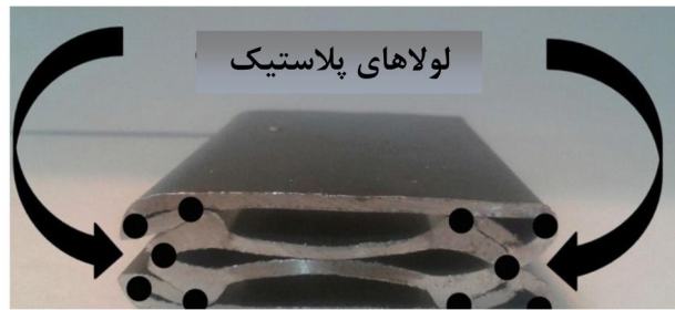
شکل 9 تشکیل پنج لولای پلاستیک در هر سمت نمونه، طی فرآیند پهن‌شدگی جانبی
