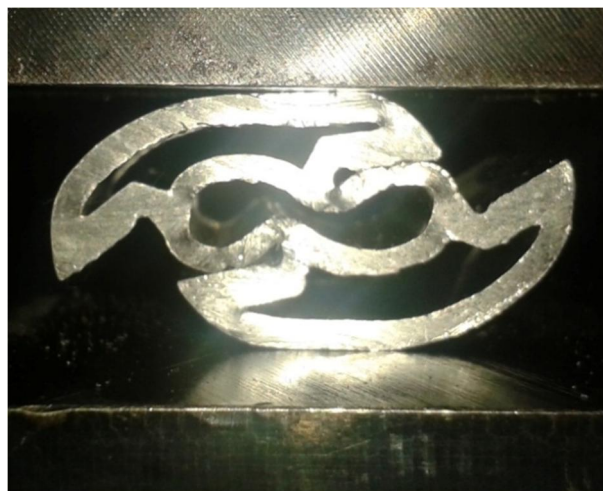
شکل 17 نمونه جدار نازک توخالی تحت بارگذاری با زاویه 60 درجه، در حین فرآیند پهن‌شدگی جانبی
