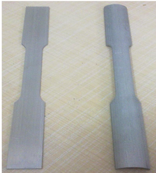
شکل 1 نمونه دمبلی شکل برای تست کشش
