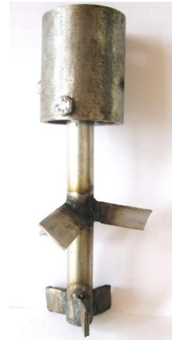
شکل 2 پره همزن مورد استفاده در این پژوهش
