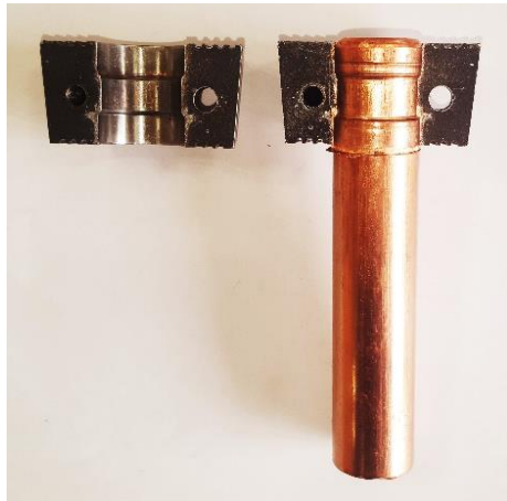
شکل ۳) تصویر لوله فرآیند اکستروژن شدن فشاری تناوبی هیدرواستاتیک شده
