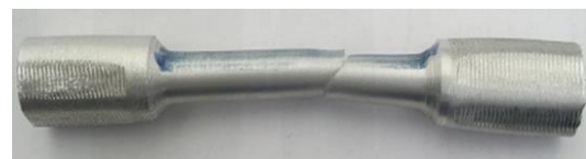
شکل ۶) نمونه ی شکسته شده بعد از تست کشش
