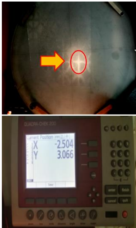
شکل ۱۲ نحوه اندازه‌گیری با دستگاه پروفایل پروژکتور
