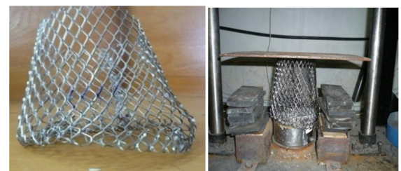
شکل 17 فروریزش نمونه مشبک 3-3 با زاویه سلول \alpha=90
