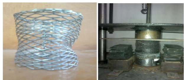
شکل 7 فروریزش نمونه مشبک 1 با زاویه سلول \alpha=0
