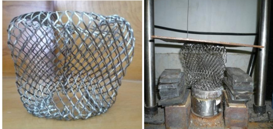
شکل 19 فروریزش نمونه مشبک 5-5 با زاویه سلول \alpha=90
