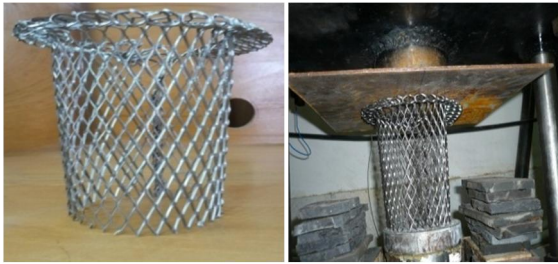
شکل 18 فروریزش نمونه مشبک 4-4 با زاویه سلول \alpha=90
