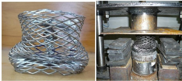
شکل 9 فروریزش نمونه مشبک 3 با زاویه سلول \alpha=0
