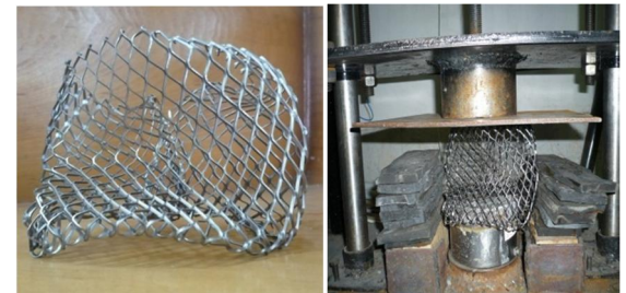
شکل 16 فروریزش نمونه مشبک 2-2 با زاویه سلول \alpha=90
