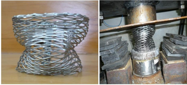
شکل 8 فروریزش نمونه مشبک 2 با زاویه سلول \alpha=0
