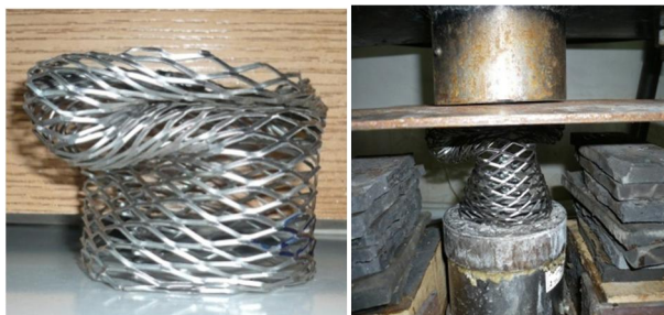
شکل 10 فروریزش نمونه مشبک 4 با زاویه سلول \alpha=0
