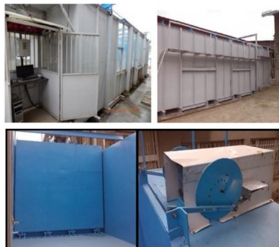
شکل ۳) نمای چپ و راست استخر موج و موج‌ساز موجود در گروه پژوهشی انرژی‌های دریا پایه
