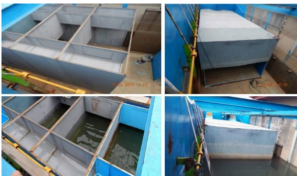
شکل ۲) نمونه مبدل انرژی موج ساخته شده در آزمایشگاه با مقیاس ۱:۱۰
