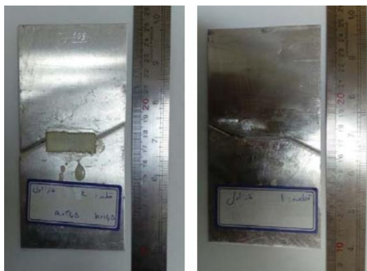
شکل ۸) الف- نمونه شماره ۱ (بدون وصله)، ب- نمونه شماره ۴ (نمونه ترمیم شده با وصله مستطیلی) پس از انجام تست کشش
