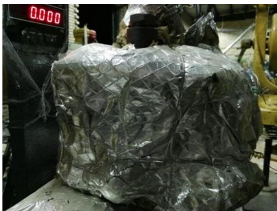
شکل ۳) مخزن بخار گازوئیل بر روی ترازو
