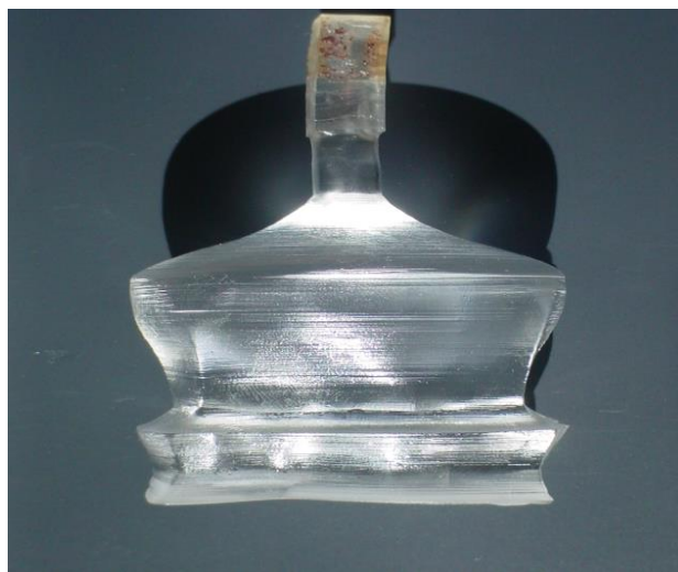
Fig. 1 the grown KCl crystal with 1% nanodiamond doping شکل 1 بلور رشد داده شده KCl با آلیاژ 1% نانوذرات الماس
