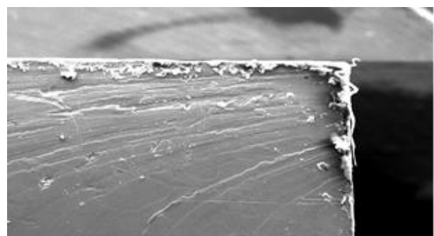
Fig. 3 SEM image of fracture cross section of 0.5% doped KCl:ND crystal شکل 3 تصویر SEM مقطع شکست بلور KCl:ND با آلیاژ 0.5 درصد ND
