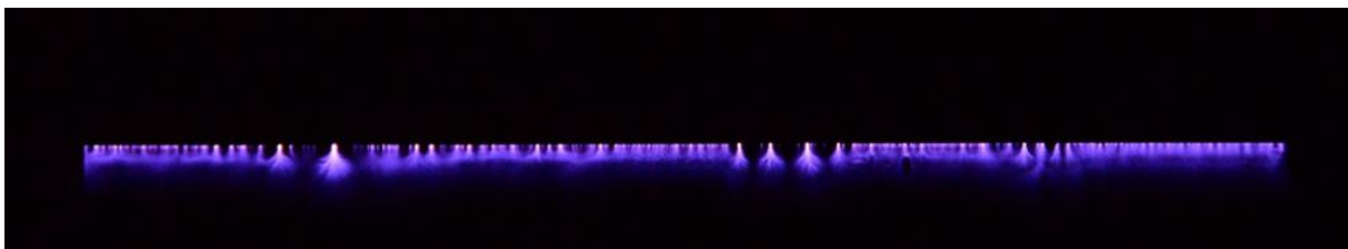
شکل ۱۶) تصویر جریان پلاسما تحت ولتاژ اعمالی ۱۴ کیلوولت (رژیم برافروختگی، بدون آهنربا و t = 2 \text{ mm} )
