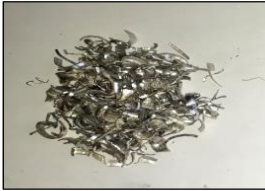
شکل ۱) براده‌های ماشینکاری شده آلیاژ Al6063
