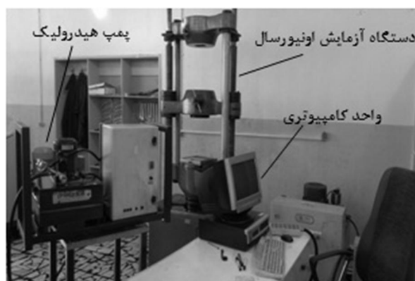
شکل 5 دستگاه آزمایش اونیورسال و پمپ هیدرولیک اعمال فشار
