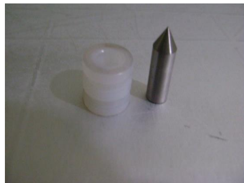
شکل ۲) پرتابه استفاده شده در آزمایش تجربی
