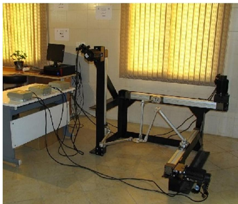
شکل 3 ربات واقعی تریپترون ساخته شده در آزمایشگاه تعامل انسان و ربات دانشگاه تهران
