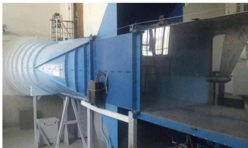
شکل 12 نمایی از تونل باد مادون صوت مرکز تحقیقات آیرودینامیک قدر
