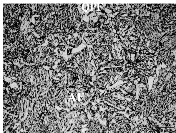
شکل ۷ ریزساختار فولاد API X65 در سرعت سرد کردن 7/5^{\circ}\text{C/s} ، (QPF فریت شبه چند وجهی، AF فریت سوزنی)
