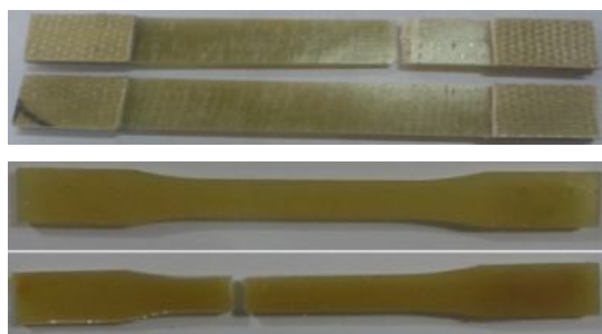
شکل 5 نمونه آزمایش کشش کشش رزین و الیاف عرضی
