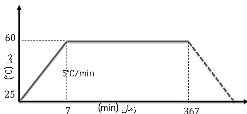
شکل 8 سیکل حرارتی برای پخت نمونه‌های FML
