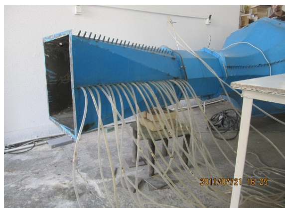
شکل ۴ اتصال شلنگ‌ها به سوراخ‌های فشار در دیفیوزر
