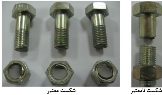
شکل 6 نمونه‌های پیچ M12 پس از شکست
