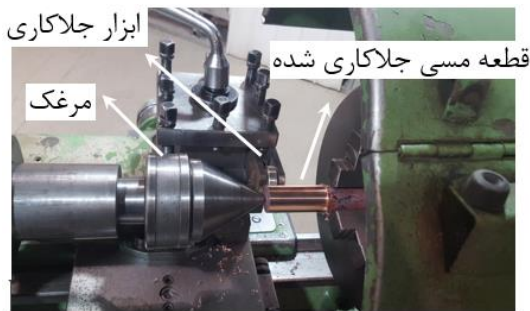
شکل ۳) اجرای فرآیند جلاکاری غلتکی بر روی نمونه مس آنیل
