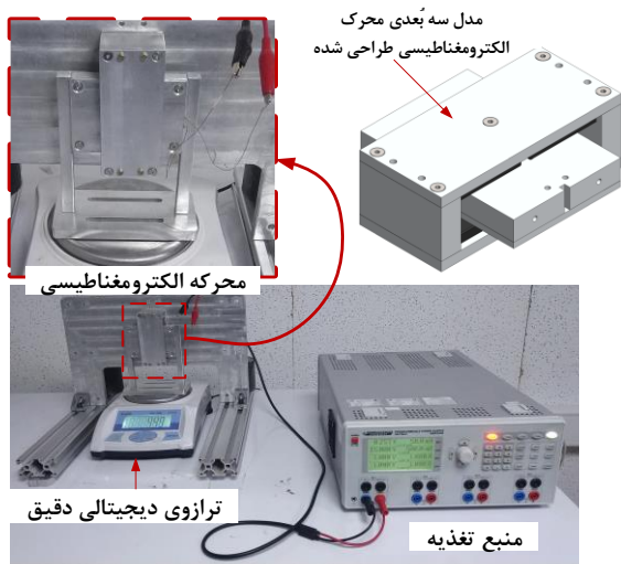
شکل ۸) نمای سه بعدی از محرک الکترومغناطیسی طراحی شده و چیدمان آزمایش‌های تجربی
