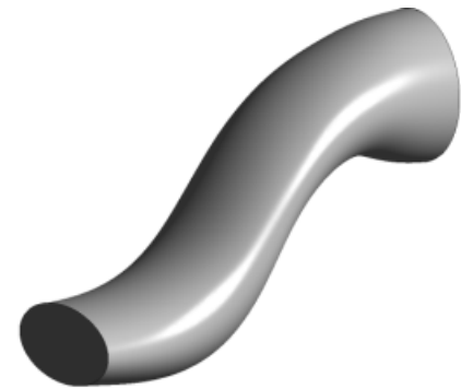
شکل ۱۴ هندسه مجرای سه بعدی با عرض ثابت و مقاطع بیضی
