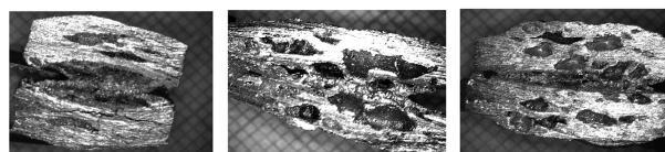
شکل ۱۲ اثر نرخ گرمایشی بر درصد تخلخل
