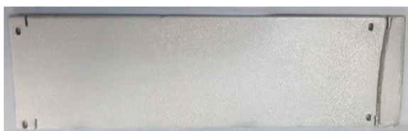
شکل ۱ ایجاد سوراخ توسط مته برای ثابت نگهداشتن ورق‌ها بر روی یکدیگر در فرایند نورد
