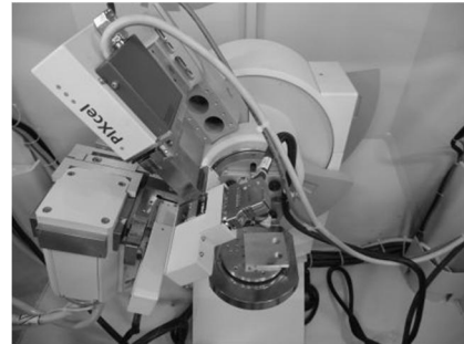
شکل 13 دستگاه پراش اشعه ایکس برای اندازه‌گیری تنش پسماند
