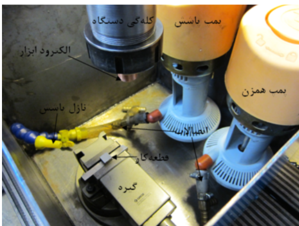
ب) نحوه قرارگیری پمپها، اتصالات، گیره و کله‌گی درون مخزن
