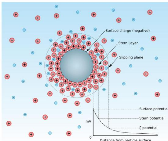
**شکل 10** نحوه قرارگیری یون‌ها در اطراف ذره باردار و محل محاسبه پتانسیل زتا
