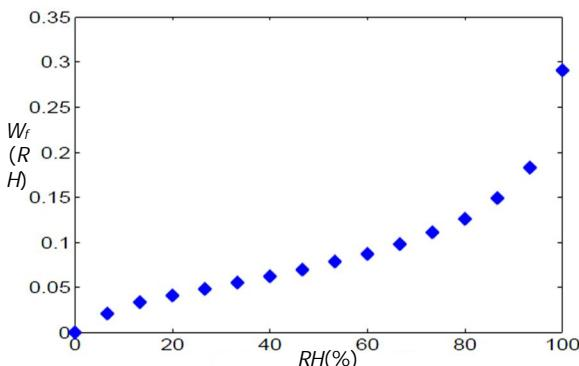
شکل 2 نمودار اندازه‌گیری تجربی آب جذب شده توسط الیاف بر حسب رطوبت نسبی [18]
