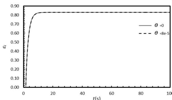
**شکل 11** نمودار کسر حجمی مایع در سطح خارجی پارچه برای دو حالت وجود و عدم وجود لایه الکتریکی دوگانه در پتانسیل زتا 3 میلی‌ولت
