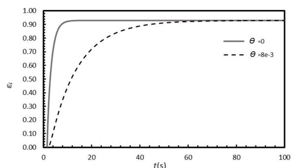
**شکل 8** نمودار کسر حجمی مایع برای دو حالت با و بدون درنظر گرفتن لایه الکتریکی دوگانه برای پارچه با تخلخل 0.95
