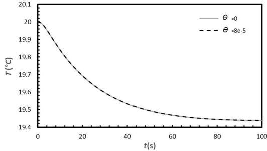
شکل 12 نمودار تغییرات دما در سطح خارجی پارچه دو حالت وجود و عدم وجود لایه الکتریکی دوگانه برای پتانسیل زتا 3 میلیولت
