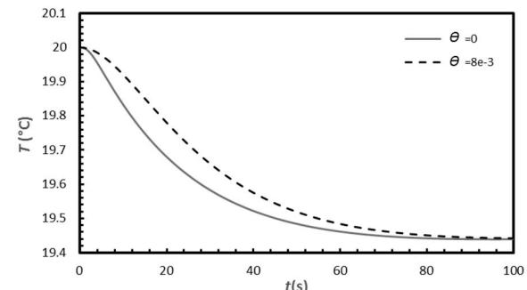
**شکل 9** دما در سطح خارجی برای دو حالت با و بدون درنظر گرفتن لایه الکتریکی
