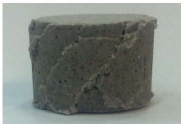
شکل 6 تغییر شکل فوم در ناحیه پلاتو و عدم بشکلهای شدن به همراه رشد ترک‌های 45°
