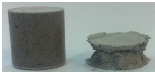
شکل 7 نمونه قبل و بعد از تست (دو مخروط ناقص روی هم بر اثر رشد ترک‌های 45°)
