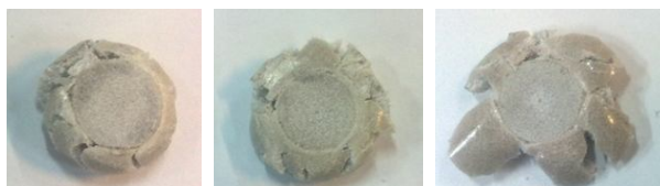
شکل 12 تغییر شکل‌های متفاوت یک نوع فوم در سه نرخ کرنش
