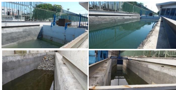
شکل ۴) نمای استخر موج، موج‌ساز و دمپر موجود در گروه پژوهشی انرژی‌های دریای پایه
