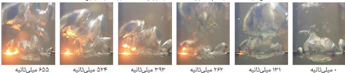
ح) رشد حباب در سیم حلقوی ۷ حلقه، شار حرارتی ۲۳۱۳ کیلووات بر متر مربع
