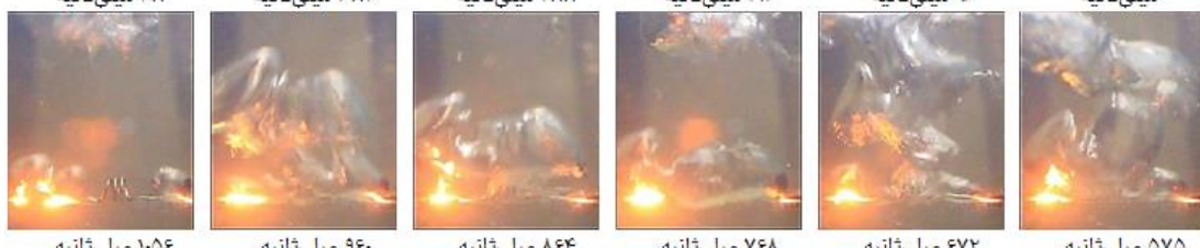
پ) رشد حباب در سیم حلقوی ۳ حلقه، شار حرارتی ۳۶۴۹ کیلووات بر مترمربع
