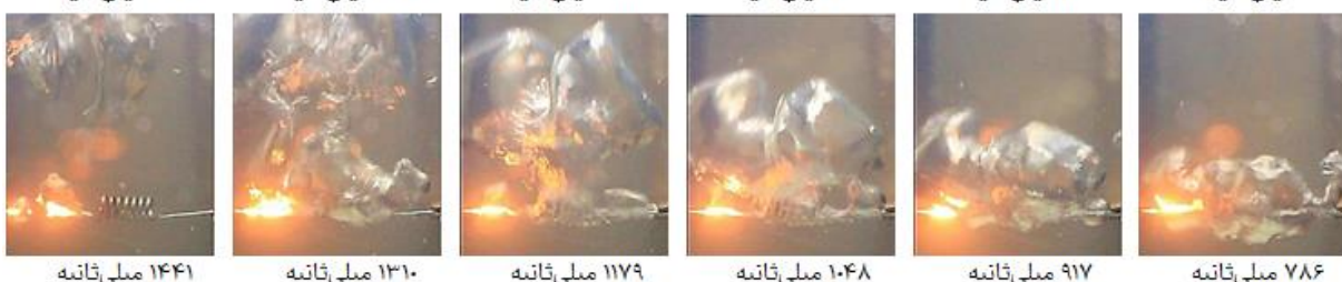
خ) رشد حباب در سیم حلقوی ۷ حلقه، شار حرارتی بحرانی ۲۹۶۵ کیلووات بر متر مربع
