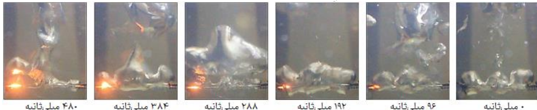
ب) رشد حباب در سیم حلقوی ۳ حلقه، شار حرارتی ۲۰۳۸ کیلووات بر مترمربع
