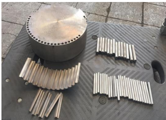
شکل ۲) گرده اولیه و نمونه‌های برش خورده با وایرکات
