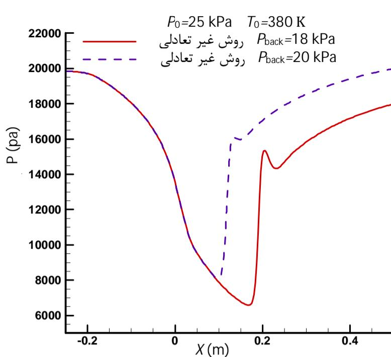
شکل 24 نحوه تغییرات فشار در محور مرکزی شیپوره A مور با روش‌های عددی غیر تعادلی در جریان حاوی شوک لرج با فشار خروجی مختلف
