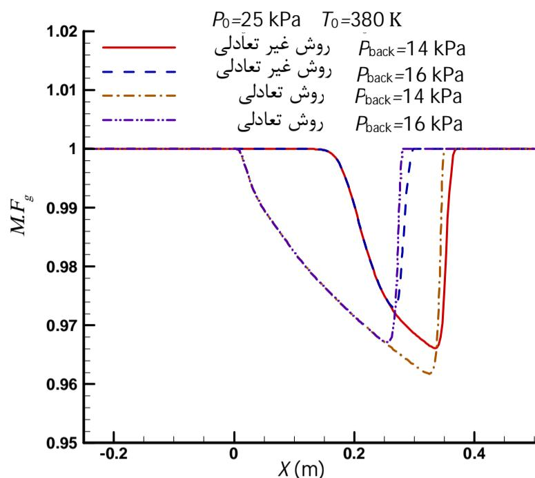
شکل 18 نحوه تغییرات کسر جرمی فاز گاز در محور مرکزی شیپوره A مور با روش‌های عددی غیر تعادلی و تعادلی در جریان حاوی شوک لزج با فشار خروجی متفاوت
