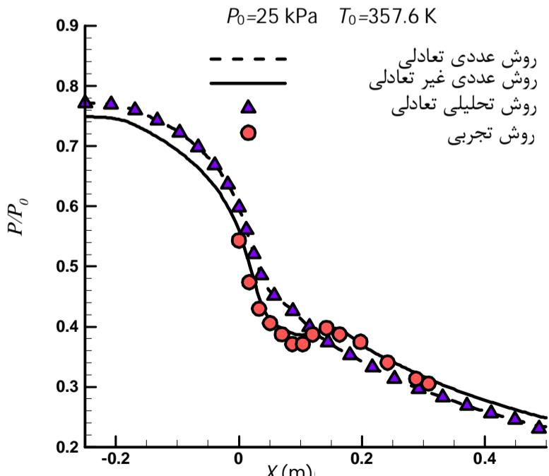
شکل 3 نحوه تغییرات فشار استاتیک در شیپوره B مور با روش‌های عددی غیر تعادلی، تحلیلی [12] و عددی تعادلی و روش آزمایشگاهی مور [6]
