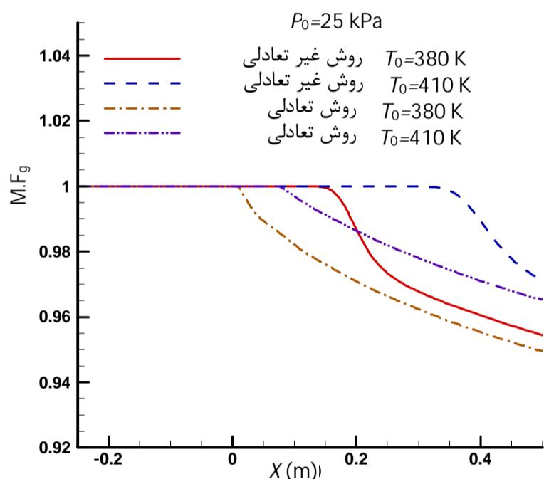
شکل 10 نحوه تغییرات کسر گاز در شیپوره A مور با روش‌های عددی غیر تعادلی و تعادلی با شرایط دمای سکون ورودی متفاوت
