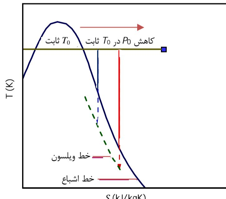
شکل 21 نمودار ترمودینامیکی دما انتروپی جهت مقایسه فرایند انبساط چگالشی تعادلی و غیر تعادلی با فشار سکون متفاوت در دمای سکون ثابت
