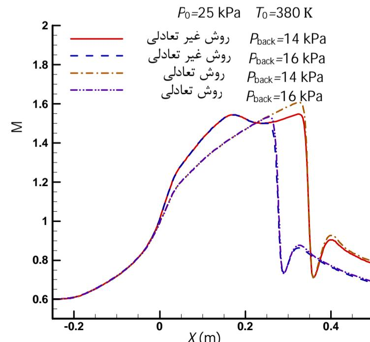
شکل 17 نحوه تغییرات عدد ماخ در محور مرکزی شیپوره A مور با روش‌های عددی غیر تعادلی و تعادلی در جریان حاوی شوک لزج با فشار خروجی متفاوت
