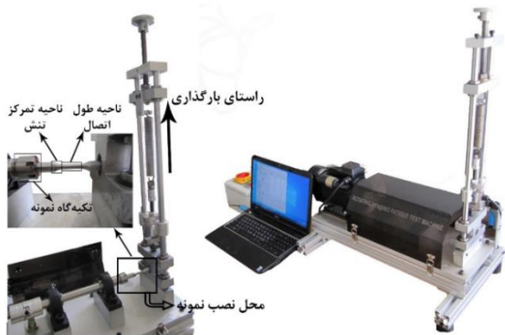
شکل ۲) دستگاه آزمایش خستگی تیر چرخان مور ساخته شده توسط محققان مقاله حاضر، محل نصب نمونه و نحوه بارگذاری با استفاده از کشش فنر
