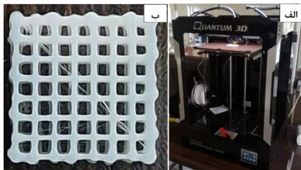
شکل ۲ (الف) پرینتر سه بعدی مورد استفاده در این پژوهش (ب) نمونه تولید شده توسط دستگاه پرینتر سه‌بعدی، داربست شماره ۳ ساخته شده از جنس PLA
