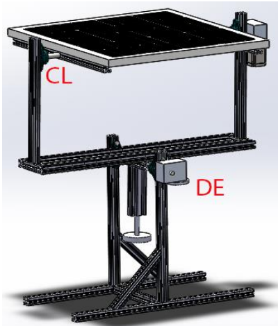
شکل ۱) شماتیک طرح پیشنهادی برای ردیاب دو محوره [27]
